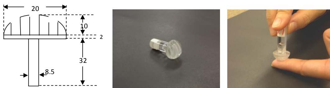
図1 触覚刺激素子 (左図の単位はmm)
